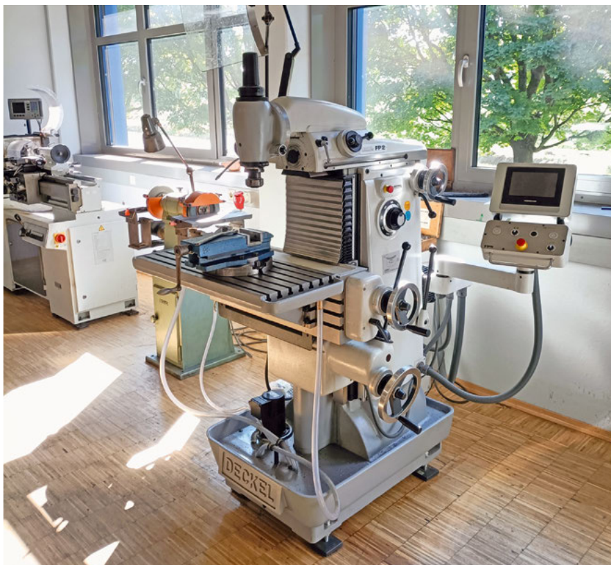
Die neue Fräs- und Bohrmaschine „Deckel FP2“
