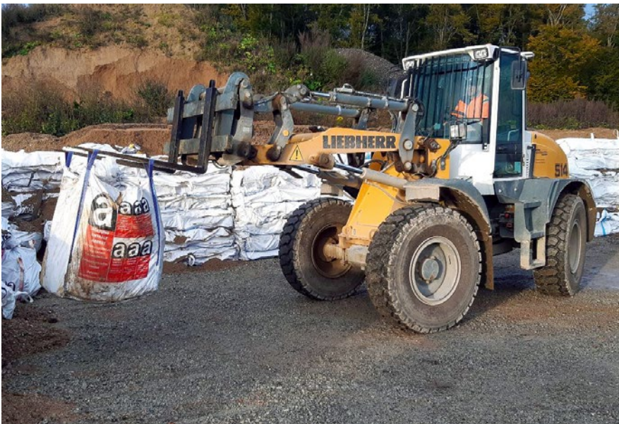
Einbau von Asbest in speziellen Big Bags auf der Deponie „Unter Kaltenbuch“
