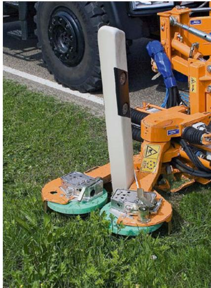
Leitpfostenmähergerät im Einsatz (Foto: Firma Mulag)
