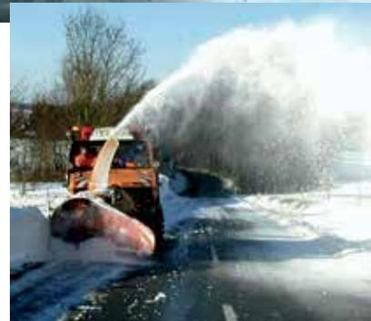
findliche Schneeschleuder ist ein im Straßenverkehr, meist jedoch nur auf Gebirgsstraßen eingesetztes Gerät, mit dem man große Mengen Schnee und Eis räumen kann. Im Vergleich zum Schneepflug ist die Schneefräse in solchen Situationen deutlich wirkungsvoller. Bei der Schneeräumung wird der Schnee nicht zur Seite geschoben, sondern über ein Schleuderrad gefräst, aufgenommen und seitlich in großem Bogen wieder ausgestoßen.
