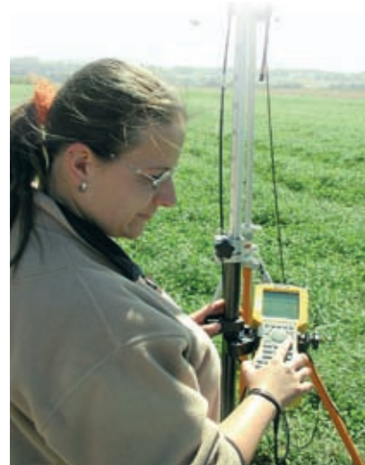
Neue Grenzpunkte werden mit GPS- Messverfahren ins Gelände übertragen.
