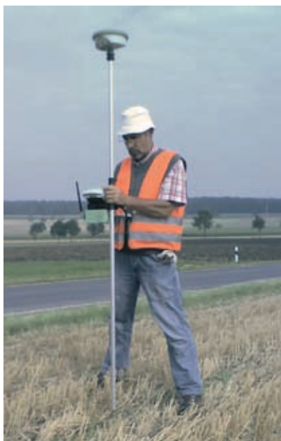
Absteckung mit GPS-Technologie (links) und Abmarkung (rechts) der neuen Grenzen
