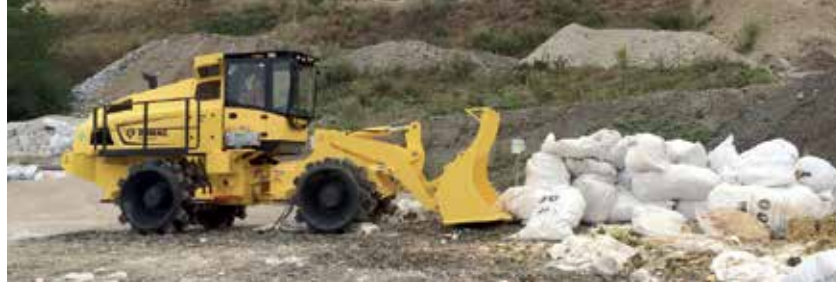
Auf der Deponie Litzholz wird ein neues Fahrzeug als Müllverdichter eingesetzt.
