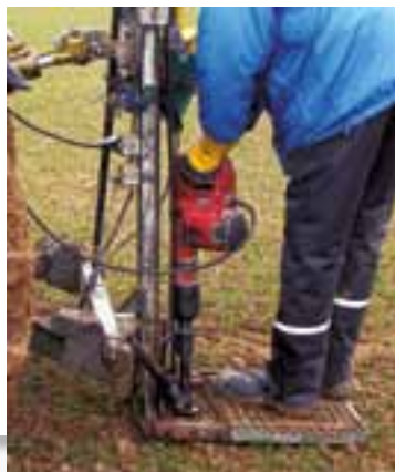
Bohrgerät zur Entnahme von Bodenproben.
